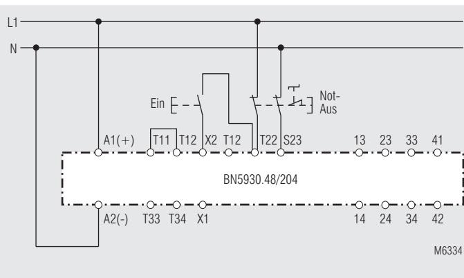
Zweikanalige Not-Aus-Schaltung mit "Querschluss-Erkennung" im Wechselstrom-Netz.
