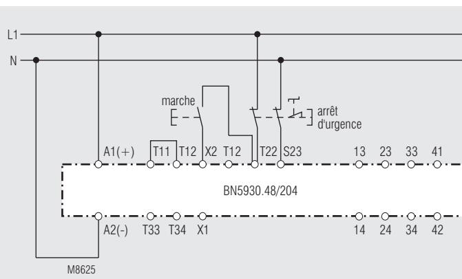
Couplage d'arrêt d'urgence à deux canaux avec "détection des courts-circuits transversaux" dans le réseau à courant alternatif.
